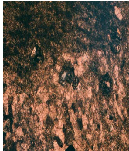
شکل ۳-۳: زمینه کلسیت با تبلور مجدد دانه درشت (بافت گرانوبلاستیک) و کلسیت‌های دانه ریز XPL100
