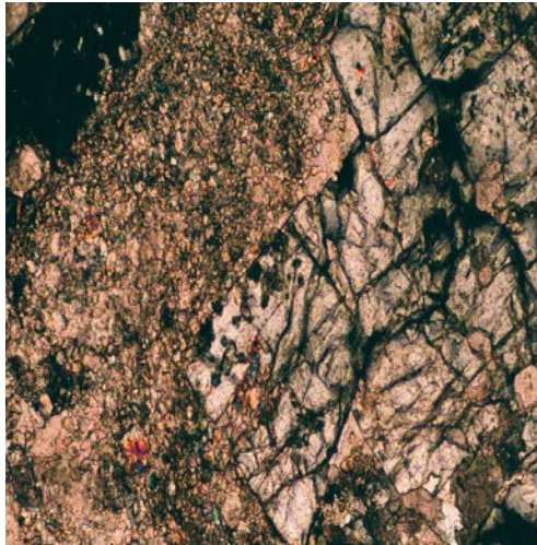
شکل ۳-۳: زمینه کلسیت با تبلور مجدد دانه درشت (بافت گرانوبلاستیک) و کلسیت‌های دانه ریز XPL100
