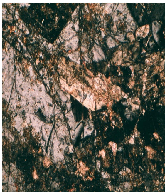
شکل ۴-۴: ادخال ولاستونیت در گارنت شکل ۴-۵: ماکل قطاعی در گارنت انیزوتروپ در این گارنتها ادخالهای فراوان پیروکسن دانه ریز دیده می شود XPL40
