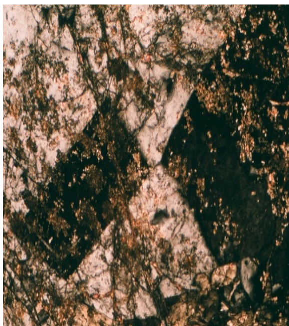
شکل ۴-۴: ادخال ولاستونیت در گارنت شکل ۴-۵: ماکل قطاعی در گارنت انیزوتروپ در این گارنتها ادخالهای فراوان پیروکسن دانه ریز دیده می شود XPL40
