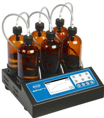
شکل (۴) دستگاه مورد استفاده برای سنجش BOD مدل ۵۳/۸۰۳۶۳/۰۲۲
