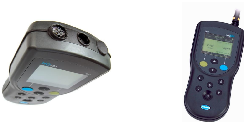
شکل (۱) دستگاه قابل حمل اندازه‌گیری پارامترهای کیفی آب
