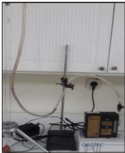
شکل ۳-۵: کالیبراسیون روتامتر با حباب صابون
