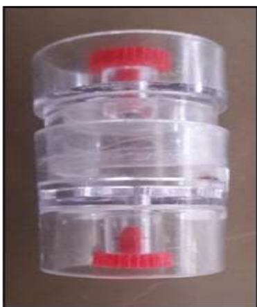
شکل ۳-۴: هولدر دوبخشی برای نمونه برداری از ترکیبات بودارکننده
