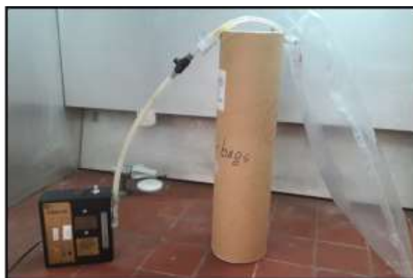
شکل ۳-۳: نمونه برداری هوا از ترکیبات بودارکننده
